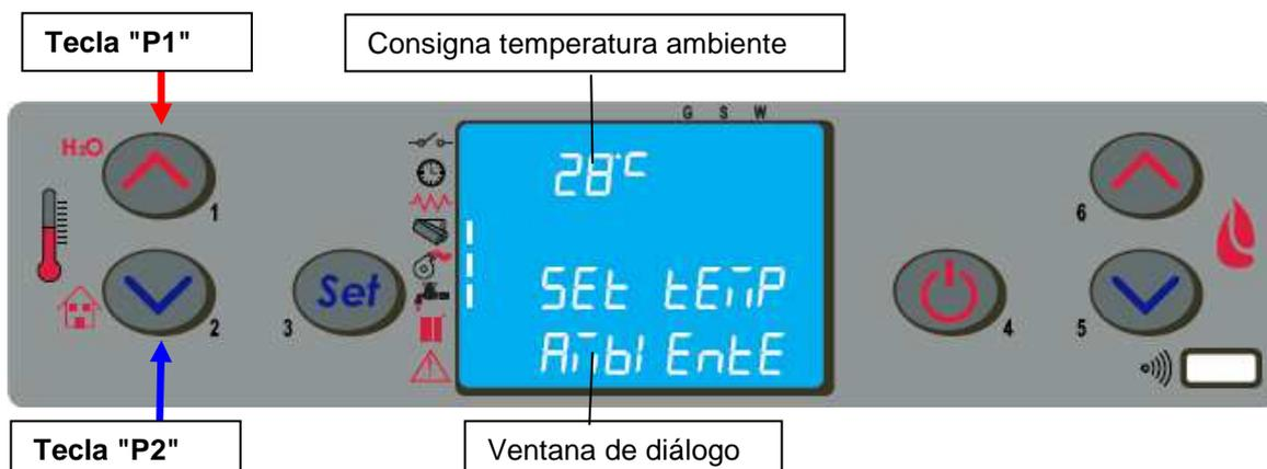
Cuando la temperatura ambiente alcanza el punto de consigna o la temperatura de los humos llega al valor máximo programado, la potencia se reduce automáticamente al mínimo, en estado de **MODULACIÓN**.
