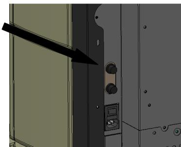
En la pared inferior del depósito, precisamente en el conducto de pellets y en la cima de la cámara térmica, hay dos sondas de temperatura conectadas a sendos termostatos de seguridad que, en caso de calentamiento excesivo, desactivan automáticamente la alimentación del pellet. En este caso, el extractor de humos o los ventiladores siguen funcionando para enfriar rápidamente la estufa. La anomalía se indica en el panel de mandos con el mensaje "AL 7 SEGUR TERMICA". Si actúa el termostato:
