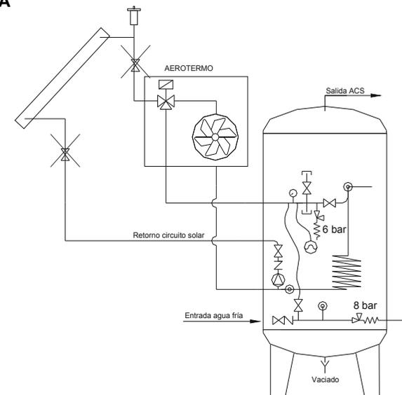
**Muy importante: no instalar válvulas de corte entre los paneles y el interacumulador**
