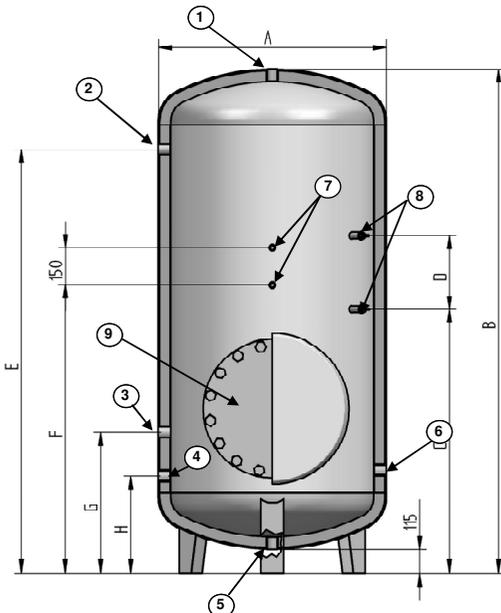
Los acumuladores están diseñados para trabajar a una presión de 8 bar y una temperatura máxima de 90 °C.
